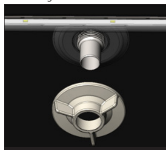
Abb. 2 Aufsetzen der Mutter auf das Rohr zum Festschrauben
