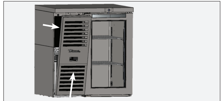
Abb. 2 Gitter erst nach vorn und dann nach oben ziehen
