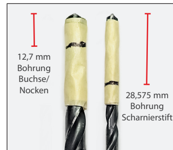
Abb. 8 Die Bohrtiefe an den Bohrern markieren.
