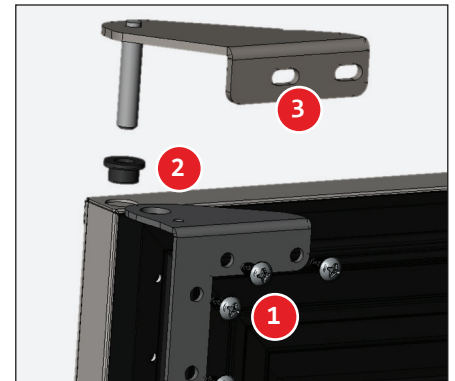
Abb. 7b Komponenten des oberen Scharniers
