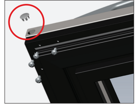
Abb. 5 Verschlussblenden und Schrauben aus der Tür entfernen
