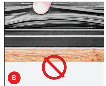
Abb. 12 Die Türdichtung zur Seite ziehen, um zu prüfen, ob sie in der Nut sitzt. A: RICHTIG; Dichtungsnut ist NICHT zu sehen. B: FALSCH; Dichtungsnut ist zu sehen.
