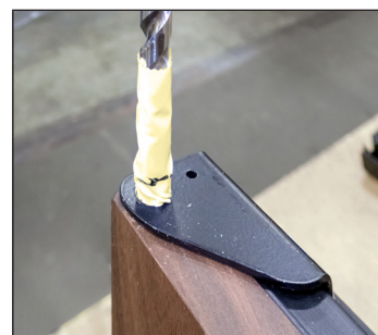
Fig. 9. Percez d'abord le trou de 3/8". ENSUITE, percez le trou de 17/64".
