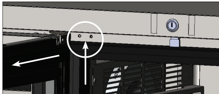
Fig. 2. Retrait de la charnière supérieure de l'unité.
