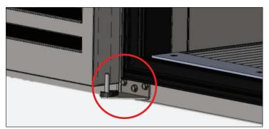
Fig. 3. Lift the door off the bottom hinge.
