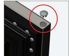
Fig. 11. Install the plug.
