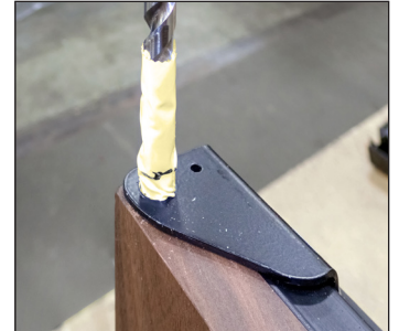
Afb. 9. Boor eerst het 3/8"-gat. Boor DAARNA het 17/64"-gat.
