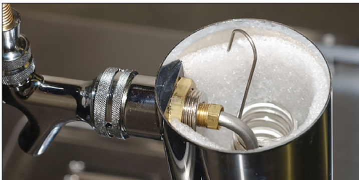
Afb. 8. Hang de koelslangklem boven de bierleiding.
