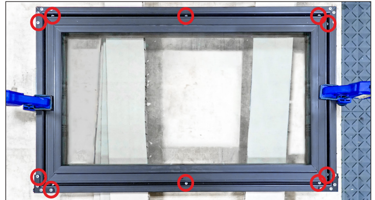
Afb. 7. Positie van de voorgeboorde gaten in de deur.
