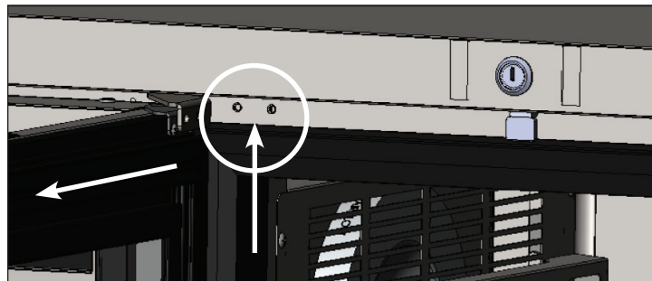
Afb. 2. Verwijder het bovenste scharnier van de kast.
