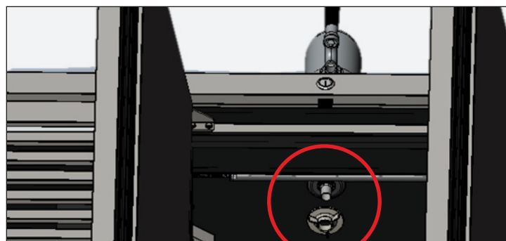
Afb. 1. Positie van de moer van de lekbakbuis.
