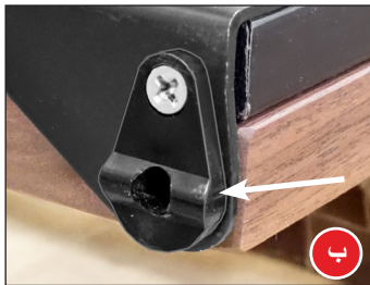
الشكل ٥. أزل دبوس وجلبة المفصلة العلوية (أ)، ورافعة كامنة الباب (ب) من كتيفات المفصلة. لا تزل كتيفات المفصلة.
