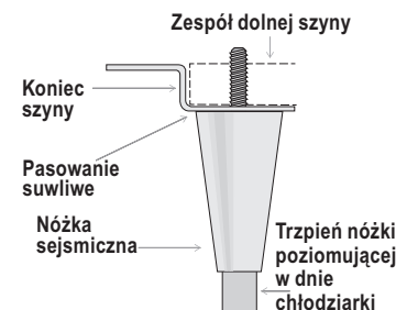
Rys. 4. Wkręcić nóżki poziomujące.
