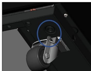
Fig. 6. Desserrage de la vis de roulette.
