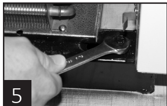
Rysunki 4-6, odkręcanie płóz od spodu szafy chłodniczej.
