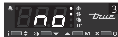
Rysunek 3: Jeśli na ekranie pojawi się „no” (nie), sterownik został odblokowany.
