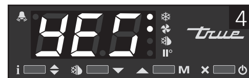
Rysunek 4: Jeśli na ekranie pojawi się „yes” (tak), sterownik jest zablokowany.
