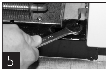
Immagini 4-6, rimozione della slitta dal fondo dell'unità.
