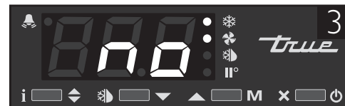
Afbeelding 3: Als er 'no' op het scherm wordt weergegeven, is de thermostaat ontgrendeld.
