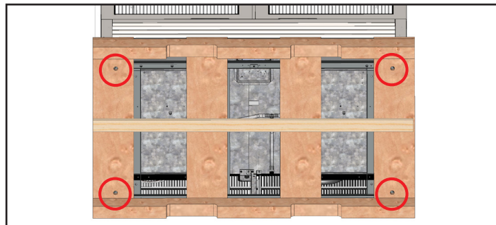
Рис. 4. Местонахождение транспортировочных болтов.
