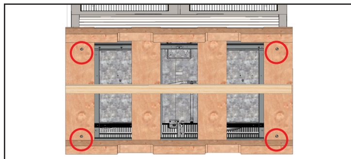
Fig. 4. Localização dos parafusos de transporte.
