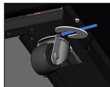
Fig. 7: Instale o(s) calço(s).
