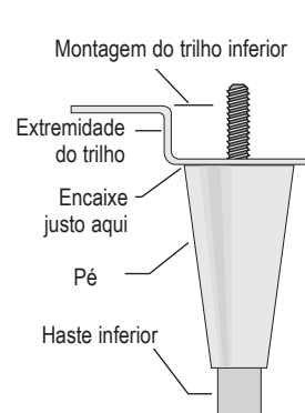
Fig. 5: Gire a haste inferior para nivelar o gabinete.
