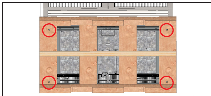
Fig. 4. Posizione dei bulloni per il trasporto.
