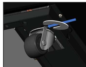
Fig. 7. Installare gli spessori.
