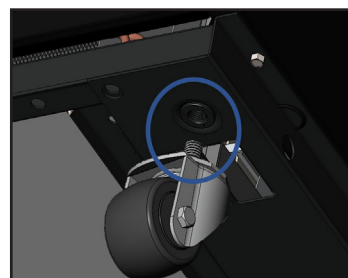
Fig. 6. Allentare il bullone delle rotelle.
