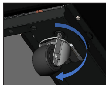
Abb. 8. Mehrere Beilagscheiben im 90-Grad-Winkel positionieren.
