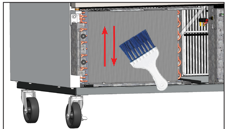
Abb. 4. Verwenden Sie die Bürste nie an den Lamellen der Rohrschlange.
