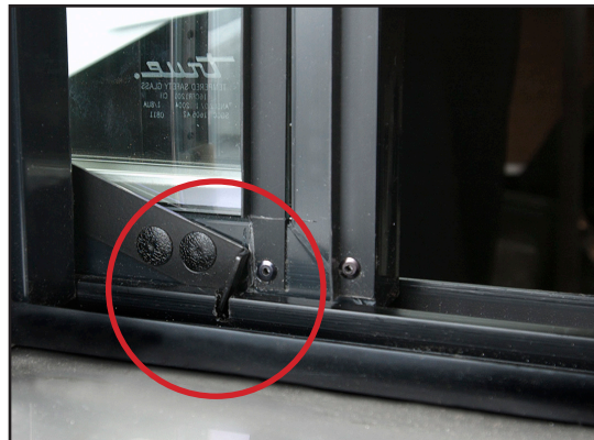
Abb. 1. Türverriegelung ist in der offenen Position (mit Kerbe eingerastet).
