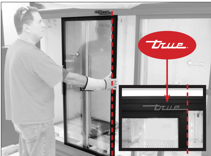
Abb. 6. Richten Sie die rechte Kante der linken Tür mit der rechten Kante des TRUE-Logos aus.
