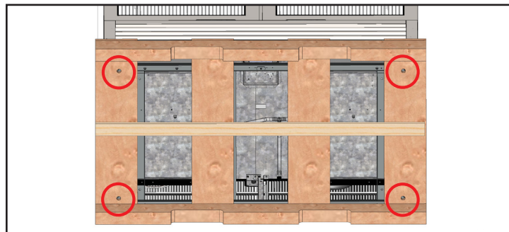
Fig. 4. Emplacements des vis de transport.
