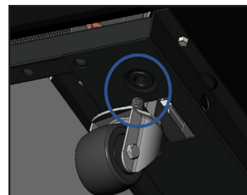
Fig. 6. Desserrage de la vis de roulette.
