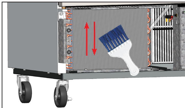
Fig. 4. Ne passez jamais la brosse au travers des ailettes de la batterie.
