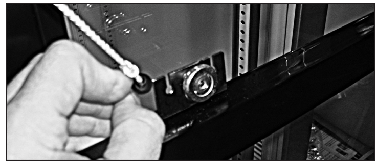
Fig. 8. La languette en plastique noir qui maintient le cordon de porte se glisse par l'arrière.
