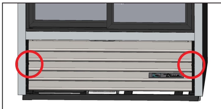
Fig. 2. Emplacements des vis de la grille à claire-voie de porte coulissante.
