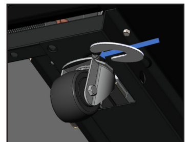
Fig. 7. Pose de la ou les cales.
