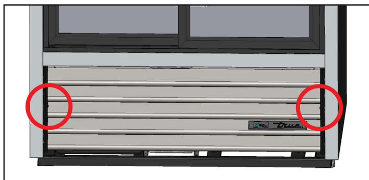
Afb. 2. Locaties van de schroeven op het rooster van de schuifdeur.
