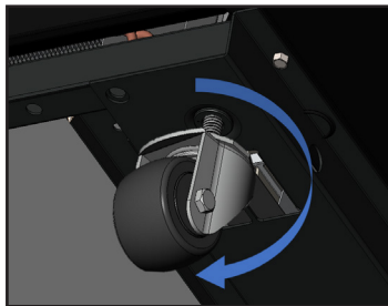
الشكل 8. ضع رفادات متعددة بزاوية 90 درجة.
