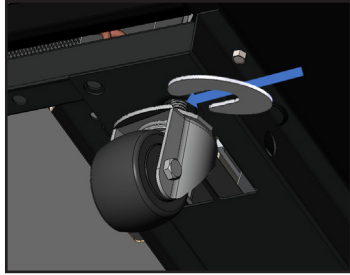
الشكل 7. تركيب الرفادة/الرفادات.
