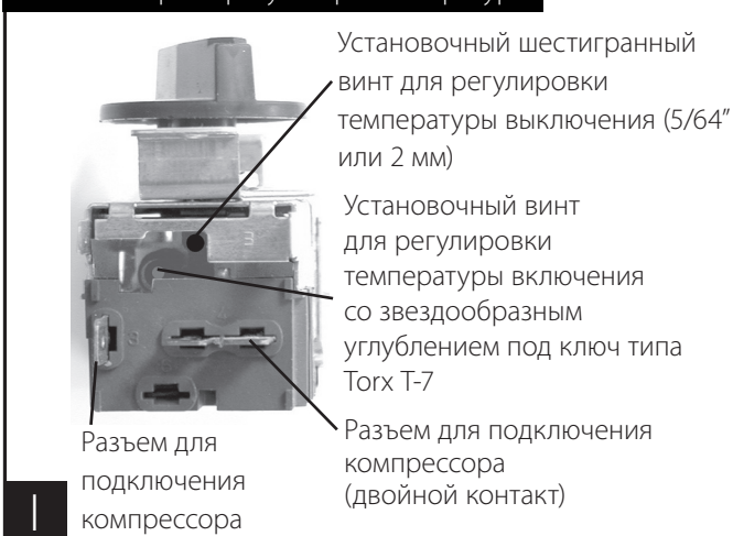
Нижняя сторона регулятора температуры
