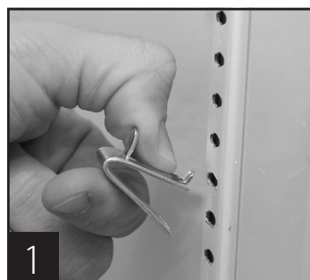
Установка верхнего язычка кронштейна полки
