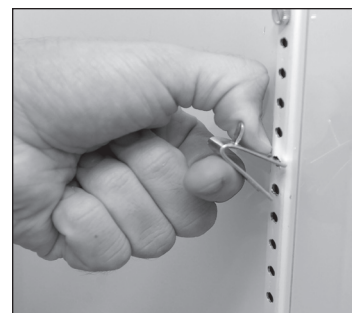
Рис. 2. Нижняя часть кронштейна должна зафиксироваться.
