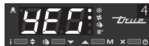
Рис. 4: Если появился символ «yes», контроллер заблокирован.
