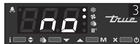
Рис. 3: Если появился символ «no», контроллер разблокирован.
