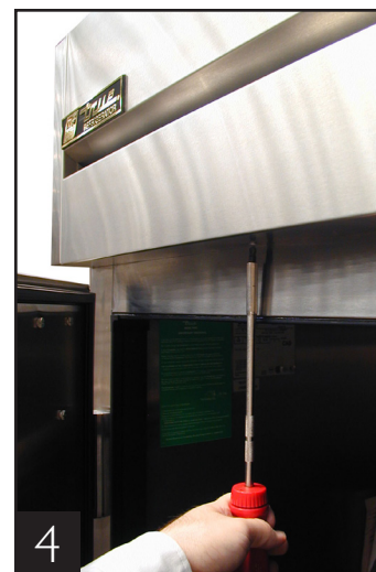
Remoção dos parafusos inferiores da proteção contra chuva.
