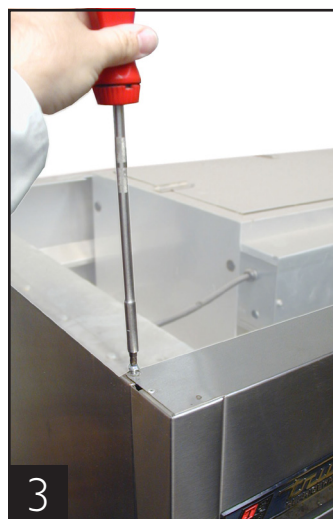
Remoção dos parafusos superiores da proteção contra chuva.
