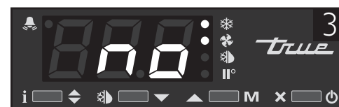
Figura 3: Se aparecer "no" (não) na tela, o controle está desbloqueado.
