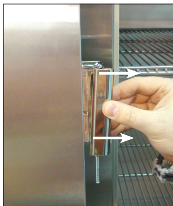
Fig. 3. Retire la cubierta de la bisagra de la puerta.
