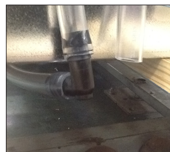
Fig. 6. Conecte el conector arponado a las mangueras del gabinete.
