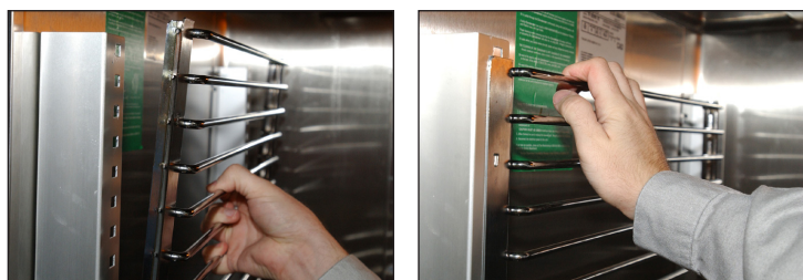
Fig. 7b. Instalación de las guías para bandejas de varillas del kit nº 2.
