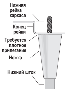
Рис. 4. Вкрутить регулируемые ножки.
