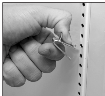
Рис. 1. Установка верхнего язычка кронштейна под полку.
