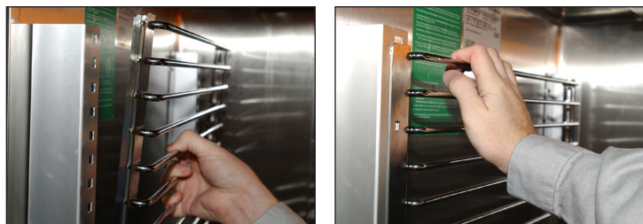
Fig. 7b. Installare le guide del ripiano a bacchetta del kit N. 2.
