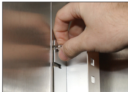
Abb. 1. Einbau der Pfeiler an der Seitenwand des Schrankes.
