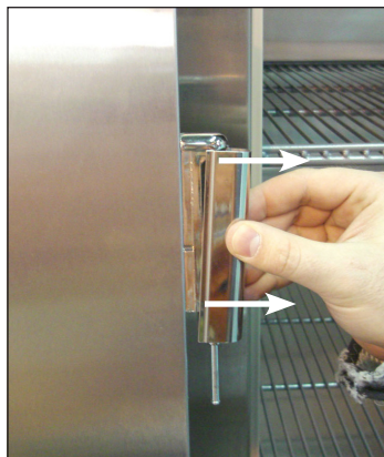
Afb. 3. Trek de scharnierplaat van de deurscharnier.
