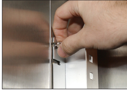
الشكل 1. تركيب العمود على جدار الخزانة.
