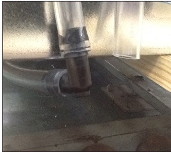
الشكل 6. قم بتوصيل التركيبات الشانكة بالخرطوم الموجودة على الخزانة.
