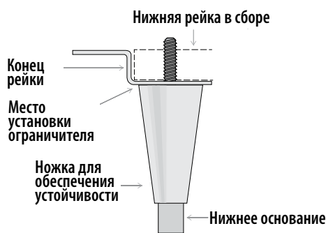
Рис. 3.2. Детали регулируемой ножки для выравнивания. Отрегулируйте нижнее основание для выравнивания устройства.
