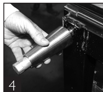
4 Inserire la gamba nella guida in basso del refrigeratore.
