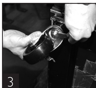
3 Die Rolle mit dem beigelegten Werkzeug festziehen.
