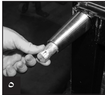
طرف الرجل قابلة للضغط بسهولة لضبط الاستواء.
