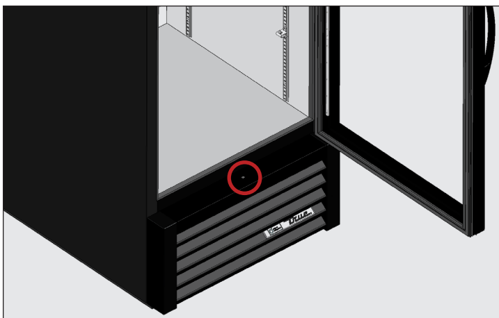
Рис. 1. Винты крепления жалюзийной решетки под распашными дверцами
