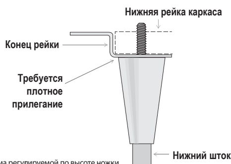
Рис. 4. Схема регулируемой по высоте ножки.
