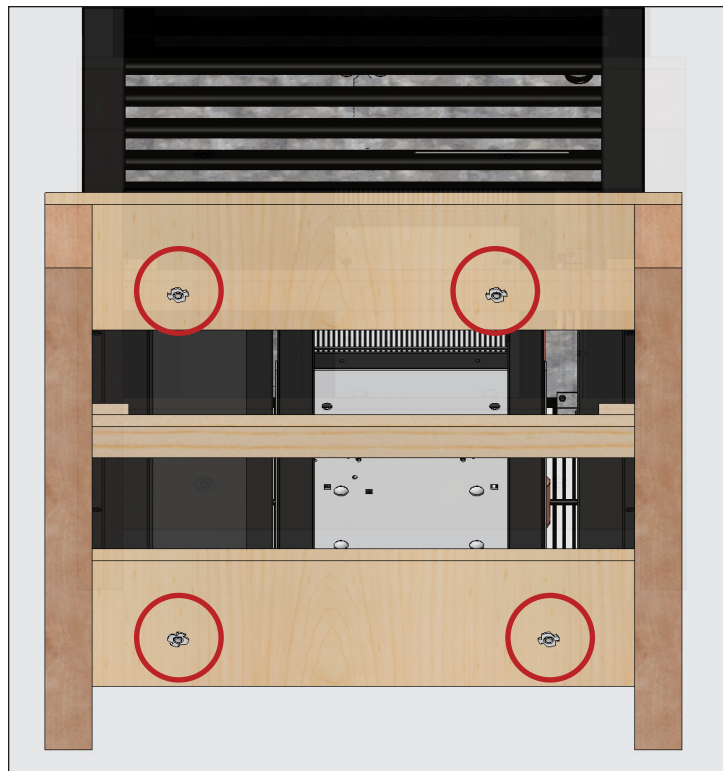
Рис. 4. Местонахождение транспортировочных болтов.
