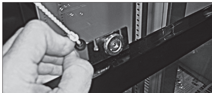
Fig. 8. Far scorrere la linguetta nera che tiene il cavo dello sportello fuori dal retro della staffa del rullo.
