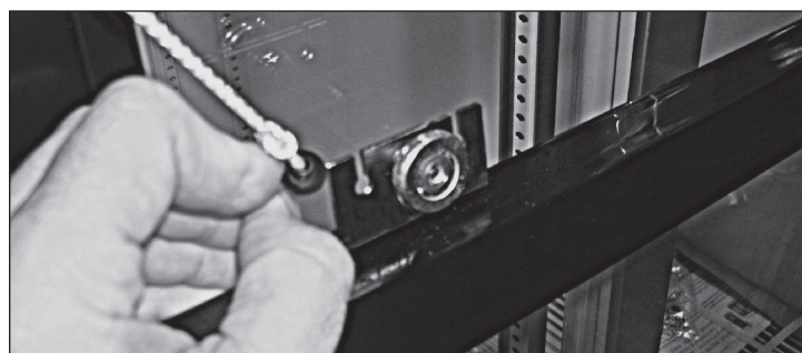
Abb. 8. Lassen Sie die schwarze Lasche, die das Türseil hält, an der Rückseite herausgleiten.
