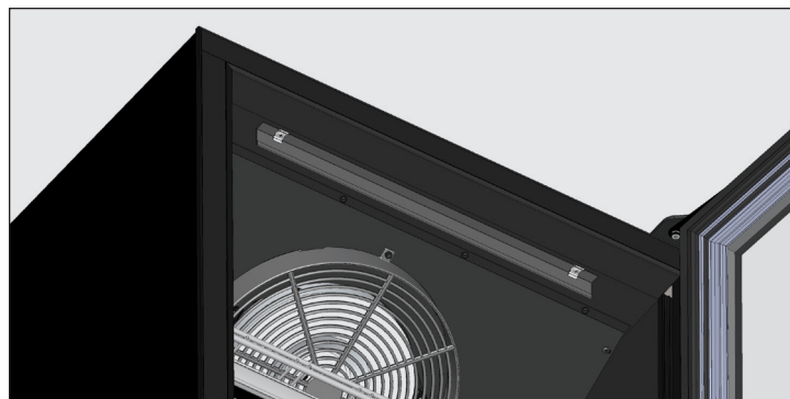
Fig. 3. Réflecteur de lumière inversé et supports de LED posés.
